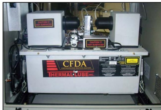
Figure 2. In-Line CFDA<sup>®</sup> (COAT) System
